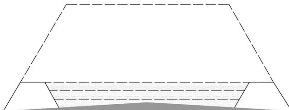
Obr. P1.3: Navezení vrstvy VEP mezi hrázkou a zhutnění; vrstva cca 0,30-0,35 m
