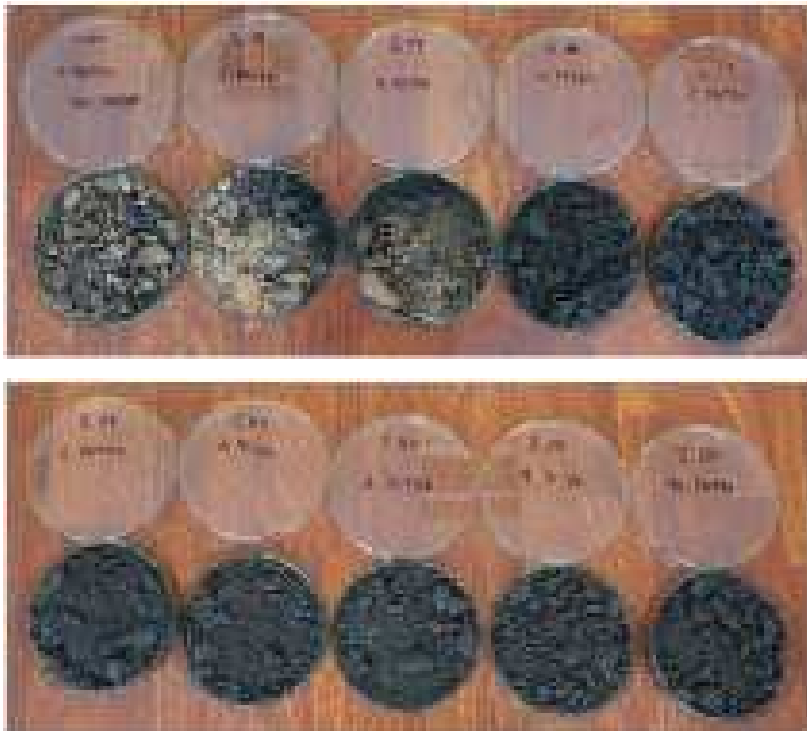
Obr. P4.6: Uhelná hlušina z odvalu Heřmanice (netříděná) po hrncovém zkoušce [3]
