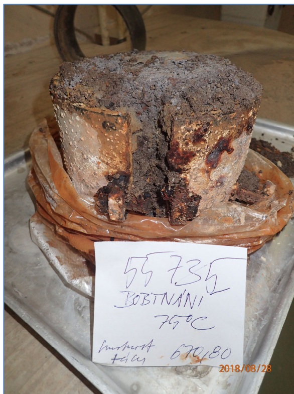
Obrázek 4 Pohled na vzorek zhutněný 100% energií Proctor standard při teplotě 75°C po 352 dnech (hypermarket TESCO) a destrukci CBR moždíře
