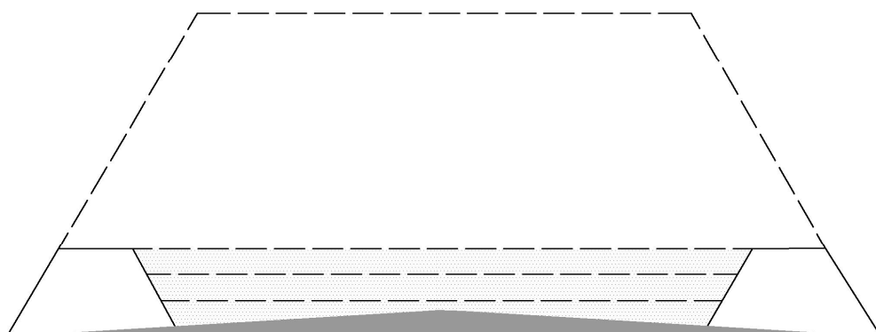
3. Navezení vrstvy VEP mezi hrázky a zhutnění. Vrstva cca 0,30 - 0,35 m
