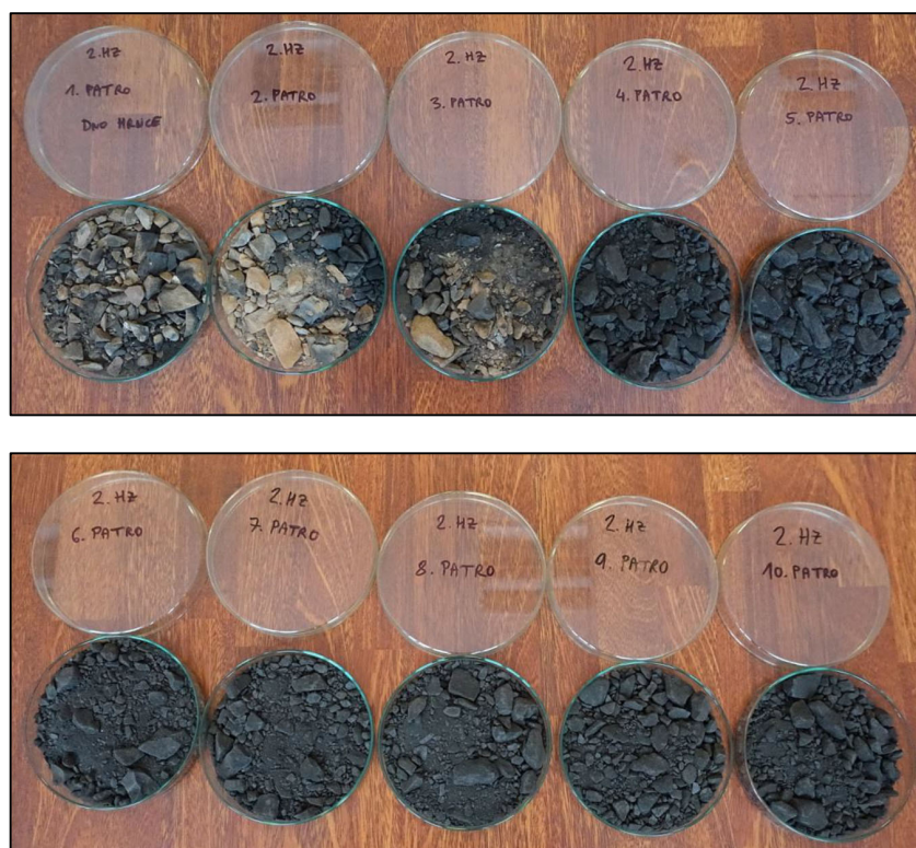
Obrázek 6 Uhelná hlušina z odvalu Heřmanice (netříděná) po hrncovém zkoušce [3]
